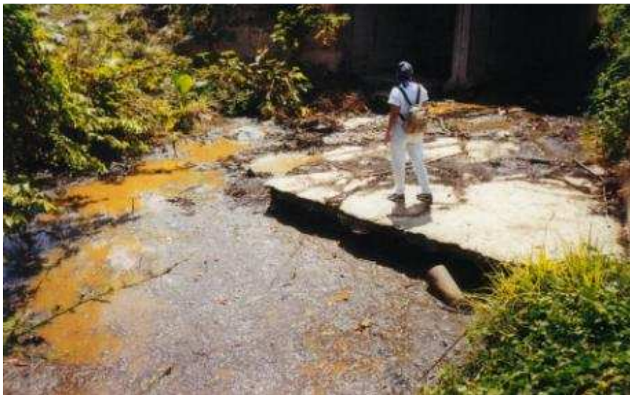
Fig. 12. Salida de un trazador colorante en un punto de descarga.
