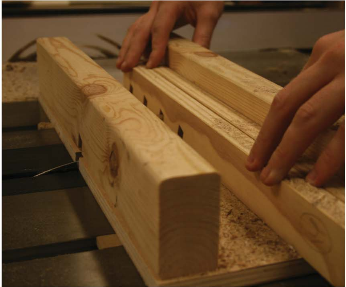
Fig. 26. Using Dado Jig
