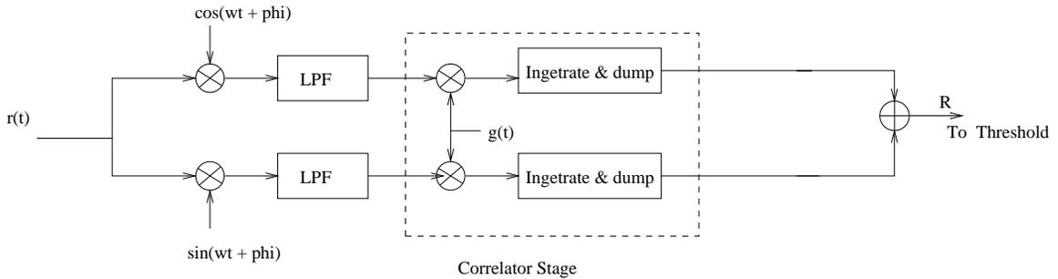
Figure 2.10. Coherent Demodulation
