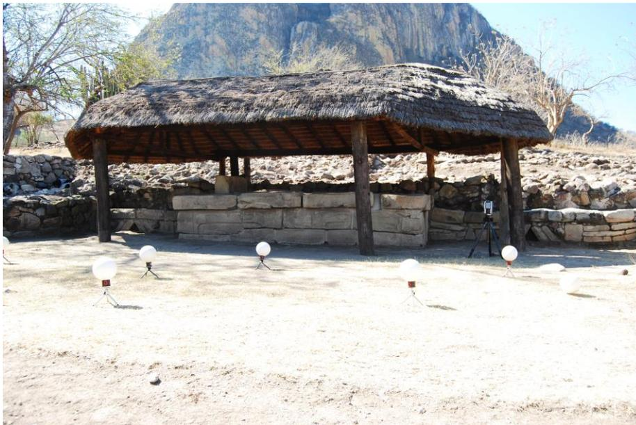
Figura 11. Colocación de puntos para el escaneo en el monumento 22.
